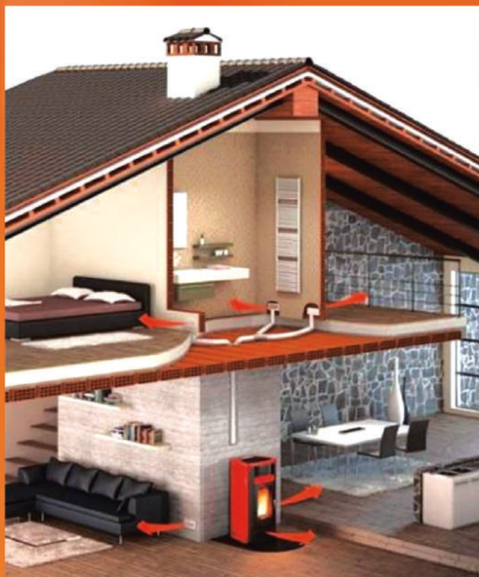
Sistema di canalizzazione aria calda fino a 16 metri
